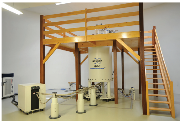
Figure 1 : Spectromètre de résonance magnétique nucléaire (RMN) 800 MHz pour applications liquides, solides et matière molle.
